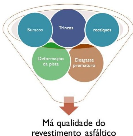
Figura 6: Alguns tipos de patologias de revestimento asfáltico
